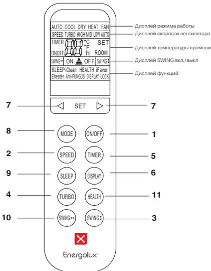
1. Кнопка ON/OFF – включение/выключение.
